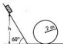
**17.** Un bloque de 2 kg se desliza por un plano inclinado  $60^\circ$  con respecto a la horizontal, con coeficiente de rozamiento 0,15. Al llegar al final del plano debe rizar el rizo sin rozamiento de la figura, situado en el mismo plano vertical que la trayectoria de descenso, de 2 m de radio. ¿Desde qué altura mínima debe caer para completar el rizo?
